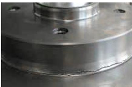
Bild 1c: Riss im Übergang Hut-Reibring
