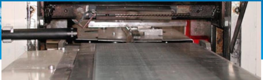
Bild 3a: Blick von der Auswurfseite. Das schwarze Sensor-Mikrofon links ist einfach am Maschinenrahmen angeschraubt
