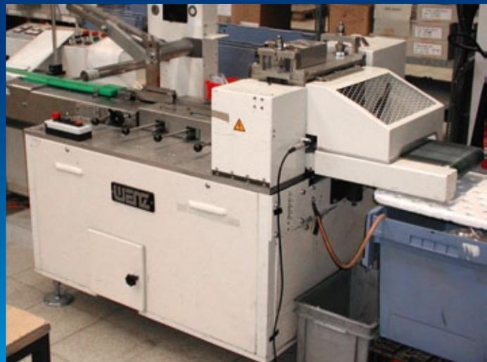
Bild 1: Akustisch überwacht: eine Verpackungsmaschine für Halogenleuchtmittel
