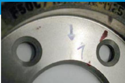
Bild 1a: Riss in der Anschraubfläche
