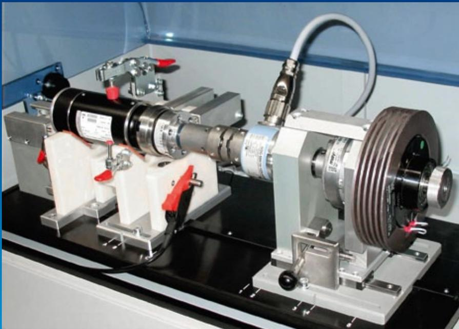
Bild 2: Tischprüfstand für die Geräusch- und Funktionsprüfung von EC-Antrieben. Er ist schnell umrüstbar und eignet sich so auch für die Prüfung kleinerer Losgrößen (Foto RTE / ebm-papst St. Georgen)
