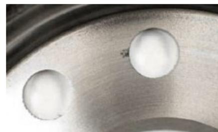
Bild 2: Oberflächliche Pore wird optisch erkannt
