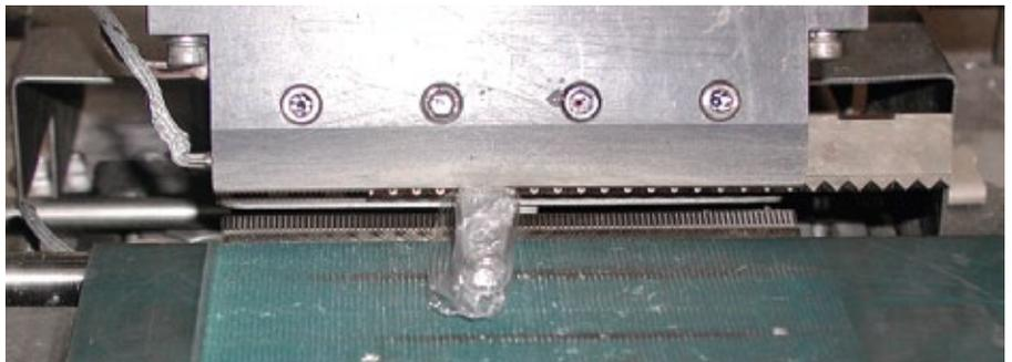
Bild 3b: Richtige Einstellung ist wichtig, die Verschlusswalze muss knapp hinter dem Leuchtmittel versiegeln
