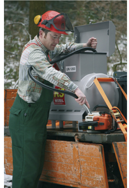
Bild 2: Auch Vergaserkraftstoff kann per KS-Mobil Easy direkt vor Ort sauber und sicher nachgefüllt werden.
