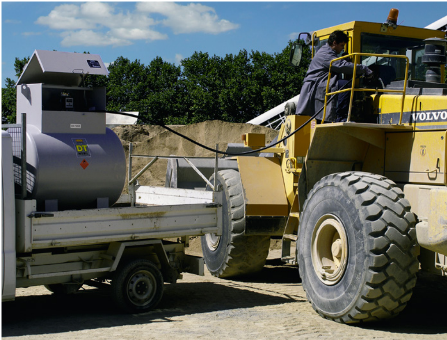
Bild 1: Bis zu 3000 l Dieselkraftstoff können so auf der Baustelle bereitgestellt werden. Ein stabiler Staukasten schützt vor Beschädigung und Diebstahl.
