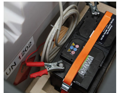
Bild 2: Stauraum für Zubehör wie den Antriebsakku für eine Elektropumpe sorgt für aufgeräumte Verhältnisse.
